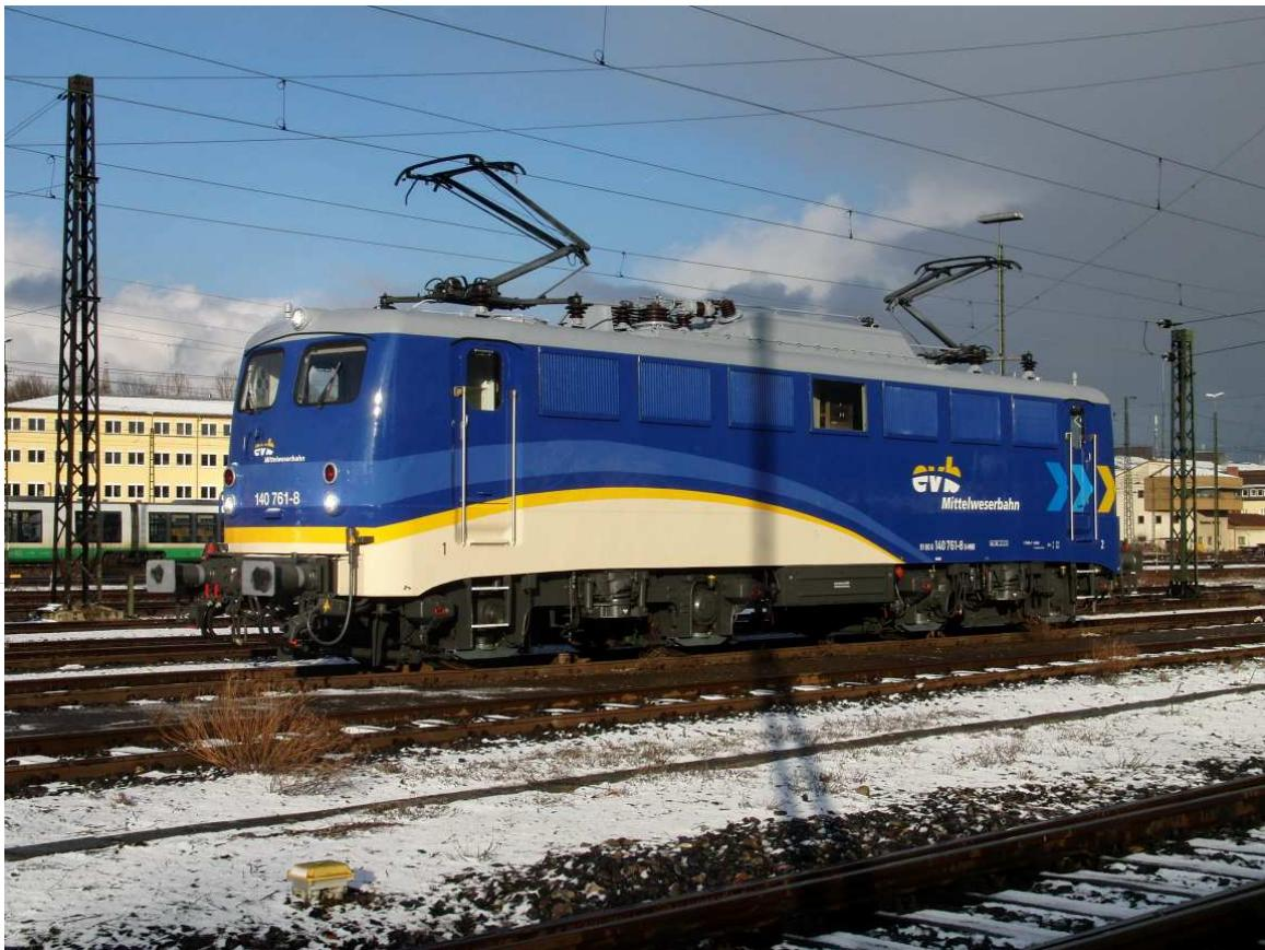
Die BR 140 ist eine vierachsige elektrische Einheitslokomotive, ideal für den Einsatz im Güterverkehr auf Hauptbahnen. Zwei Lokomotiven können in Doppeltraktion von einem Lokführer bedient werden (bis 7.400 KW). Durch die Ausrüstung mit Wendezugsteuerung und Zugheizung sind auch Einsätze im Personenverkehr möglich.
